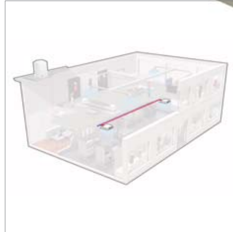
BBORU UZUNLUĞU (İÇ ÜNİTE İÇ ÜNİTE) İçeriden içeriye maksimum üniteler arası kot farkı: 4m
